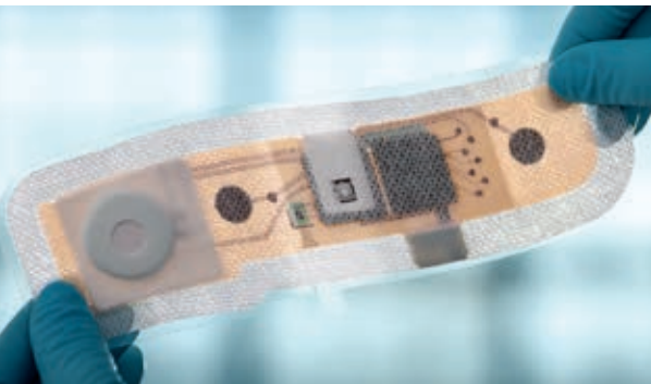
Flexibler Aufbau für ein Plug & Play-EKG
